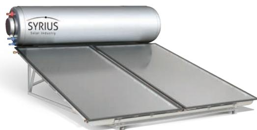
Le chauffe-eau solaire thermosiphon double paroi fonctionne en circuit fermé : l'antigel circule dans les panneaux et dans le ballon. L'eau sanitaire se trouve à l'intérieur du ballon, dans une double paroi comme un «bain-marie».
