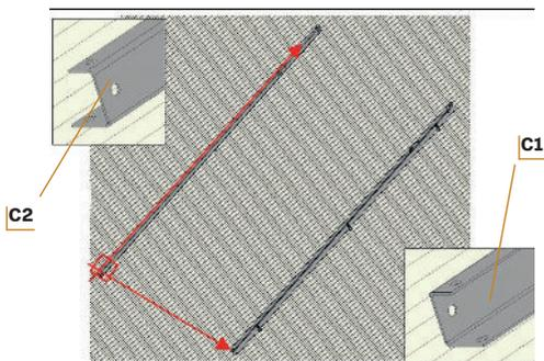
Percer les longons (C1 et C2) au niveau des tirefonds.
