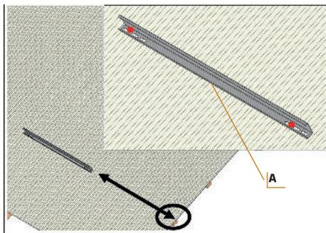
Positionner la traverse capteur (D1) au niveau d'une panne de la charpente.
