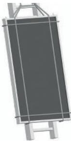
Lever les capteurs (B) sur la toiture. Pour le levage, fixer deux cordes robustes, comme montré ci-contre. Pendant la manipulation, vérifier que la corde ne recouvre pas les piquages en cuivre. Il est recommandé d'utiliser une grue pour le levage. Si nécessaire, utiliser, avec précaution, une échelle pour monter les capteurs sur le toit.
