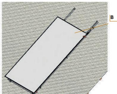
Placer le capteur (B) sur le système de montage
