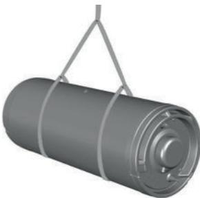
Lever le ballon sur le toit. Pour le montage, fixer deux cordes robustes, comme montré ci-contre. Nous recommandons d'utiliser une grue pour le levage. Travailler à deux : un installateur sécurise le ballon, le second le guide
