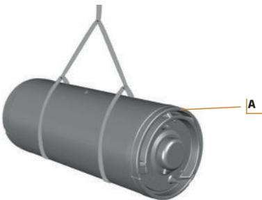
Lever le ballon (A) sur le toit. Pour le montage, fixer deux cordes robustes, comme montré ci-contre. Nous recommandons d'utiliser une grue pour le levage. Travailler à deux : un installateur sécurise le ballon, le second le guide
