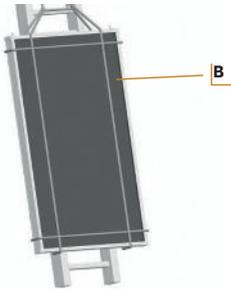
Lever le(s) capteur(s) (B) sur la toiture. Pour le levage, fixer deux cordes robustes, comme montré ci-contre. Pendant la manipulation, vérifier que la corde ne recouvre pas les piquages en cuivre. Il est recommandé d'utiliser une grue pour le levage. Si nécessaire, utiliser, avec précaution, une échelle pour monter les capteurs sur le toit.
