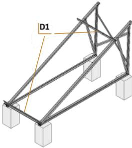
Assembler les traverses capteur (D1) sur les longerons (C1) et (C2)
