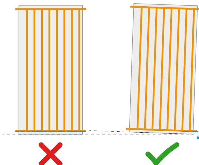
L'INCLINAISON RECOMMANDÉE EST DE 2 % SOIT 2 CM DE DÉNIVELÉ POUR 1 M.
