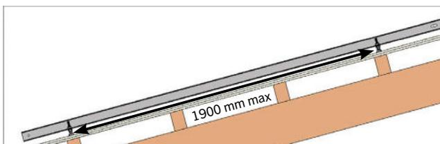
L'espacement entre les pannes ne doit pas excéder 1900 mm
