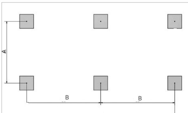
Taille minimale des plots béton : 150x150mm
