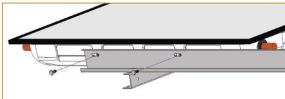
1 - Positionner et visser un capteur sur les traverses
