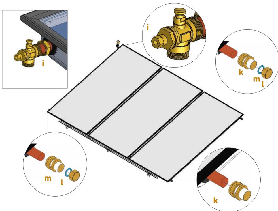
Emboîter l'ensemble croix doigt de gant purgeur d'air sur le capteur.
