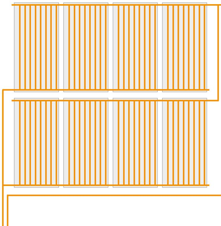
2 nappes de 4 capteurs C2000
