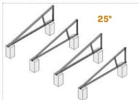
Taille minimale des plots béton : 150x150mm
