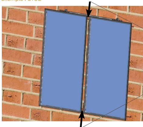
2 - Insérer les raccords 22x22 sur ce capteur. Puis positionner le second capteur en l'insérant dans les raccords 22x22 et le visser également sur les traverses
