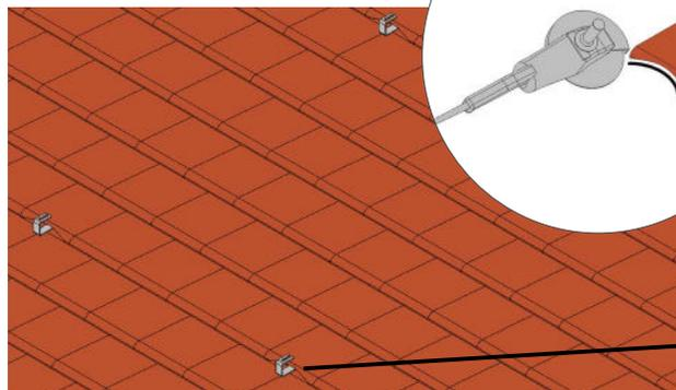
Meuler les tuiles avant de les positionner sur les crochets
