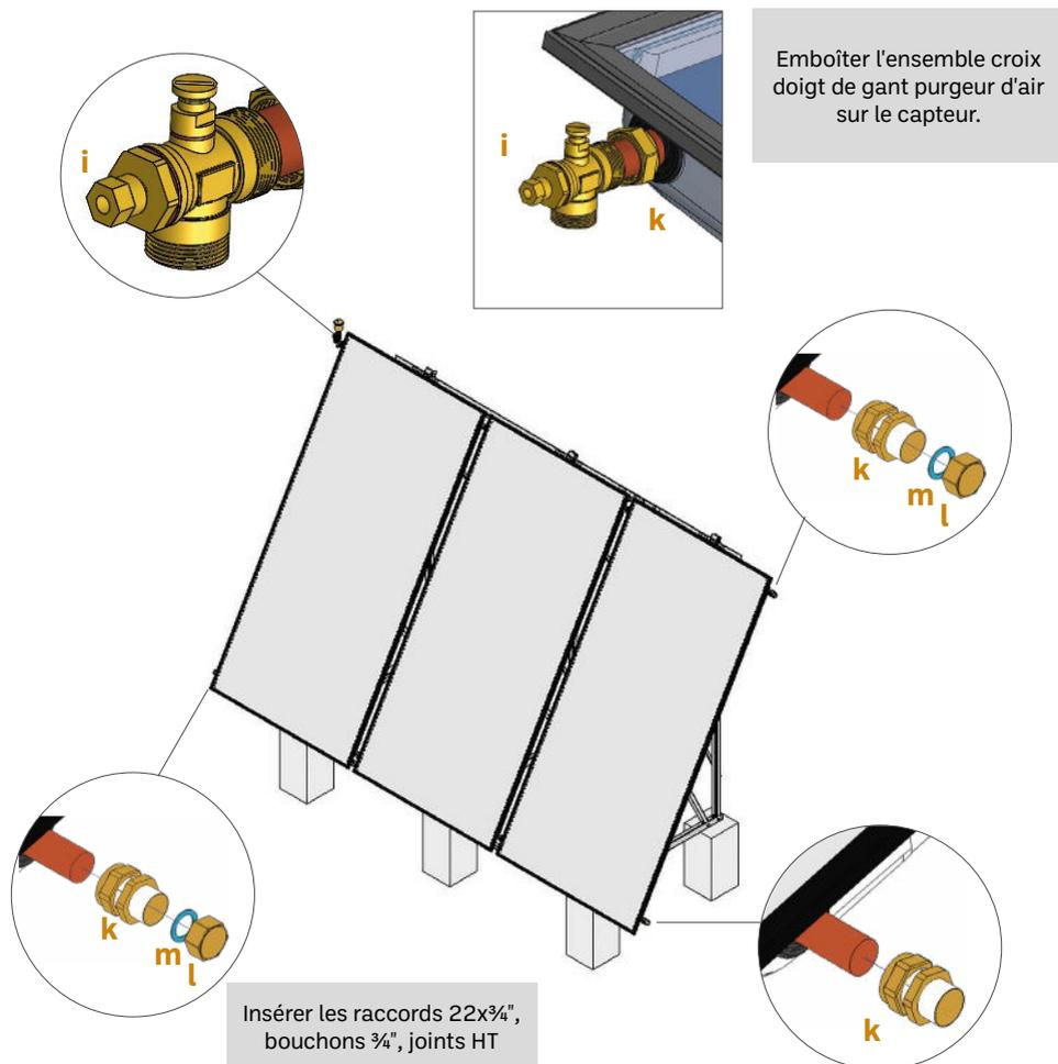
Emboîter l'ensemble croix doigt de gant purgeur d'air sur le capteur.
