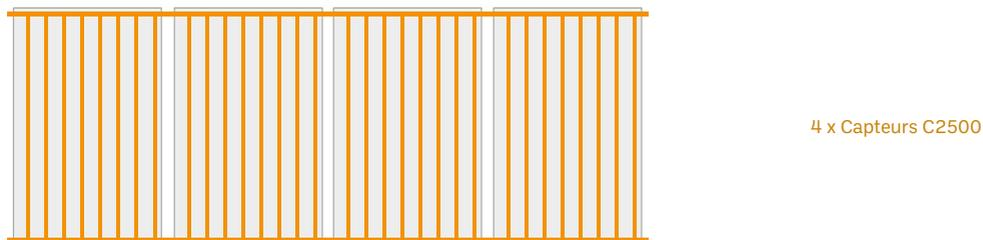
SI DES LYRES DE DILATATION SONT UTILISÉES POUR S'AFFRANCHIR DES PROBLÉMATIQUES DE DILATATION, ALORS IL EST POSSIBLE D'ALIGNER JUSQU'À 6 CAPTEURS DE 2,5 M2. ATTENTION À NE PAS CRÉER DE POINT BAS DANS LE CAS D'UNE INSTALLATION AUTO-VIDANGEABLE.
