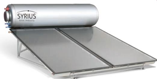
O aquecedor solar de parede dupla funciona em circuito fechado: o anticongelante circula nos colectores e rodeia o tanque principal de armazenamento. A água quente doméstica está contida num tanque de armazenamento interno que funciona como «banho-maria», por contacto com o fluido proveniente dos colectores.
