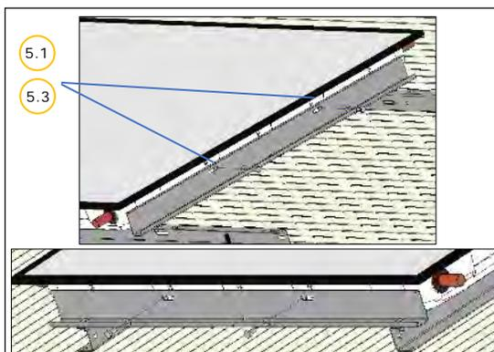
Atornille el captador a los travesaños (4.3) con tornillos M8 (5.1) y arandelas planas (5.3).
