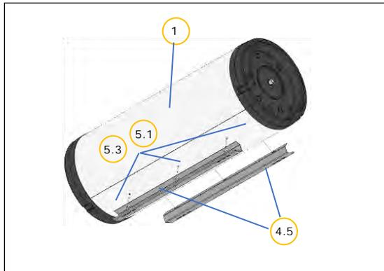
Retirar la lámina protectora de la placa inferior del acumulador y coloque los travesaños del depósito (4.5 ò 4.6) al tanque de almacenamiento con los tornillos M8 (5.1) y las arandelas planas (5.3).
