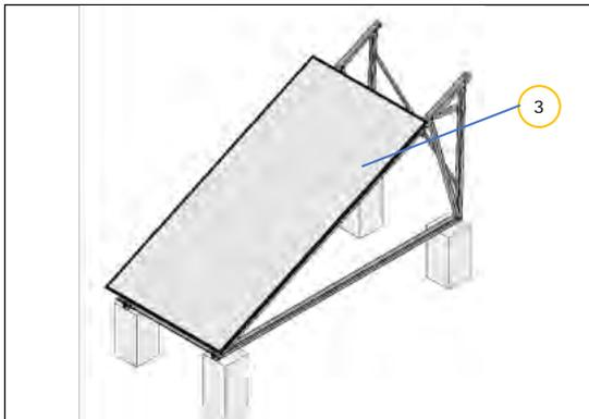
Coloque el captador (3) en la estructura.
