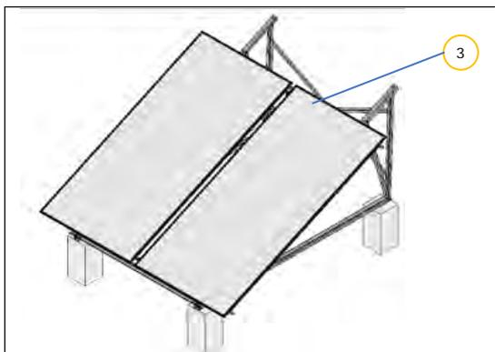
Coloque los captadores (3) en la estructura.
