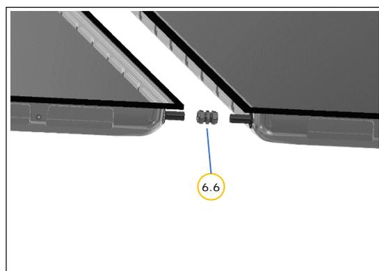
Conecte los captadores con conexiones de 22x22 (6.6)
