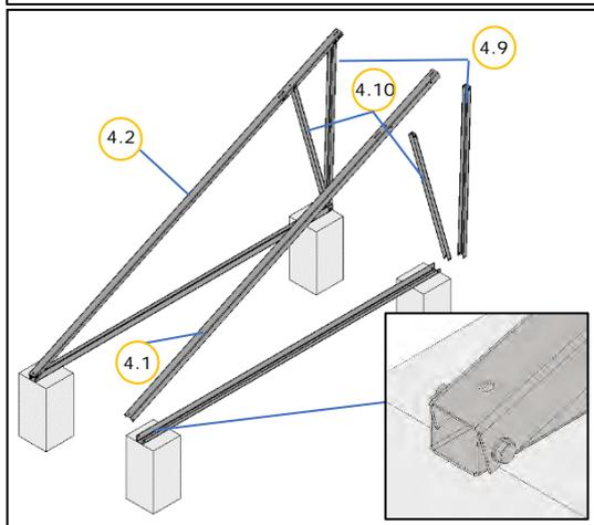
Ensamblar las barras longitudinales (4.1) y (4.2), las patas traseras (4.9) y los refuerzos (4.10) a las correspondientes barras base (4.7) y (4.8).
