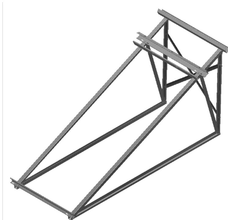
Vista de la estructura para cubierta plana (STT) (4) del TS-304INOX
