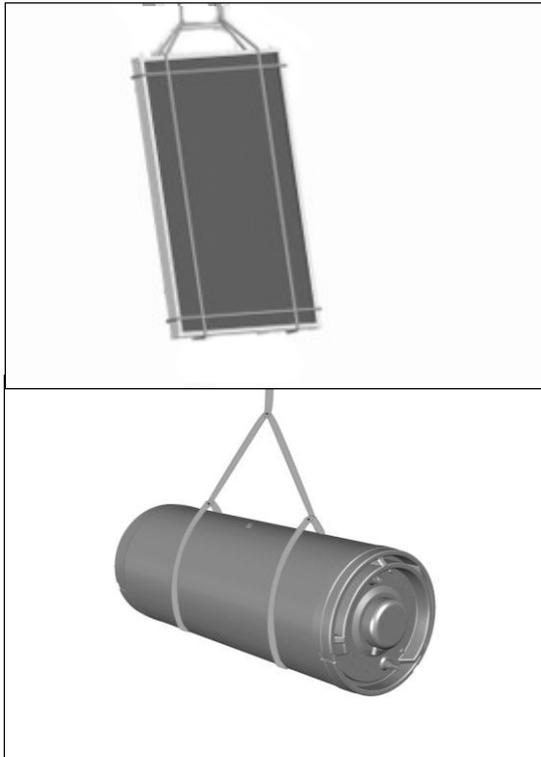
Suba los captadores (3) a la cubierta. Para subirlos, utilice eslingas resistentes como se muestra en la figura. Durante la manipulación, compruebe que la eslinga no cubra las conexiones de cobre. Se recomienda utilizar una grúa para su elevación.
