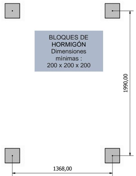
Obsérvense las dimensiones dadas arriba para la colocación de los bloques de hormigón.
