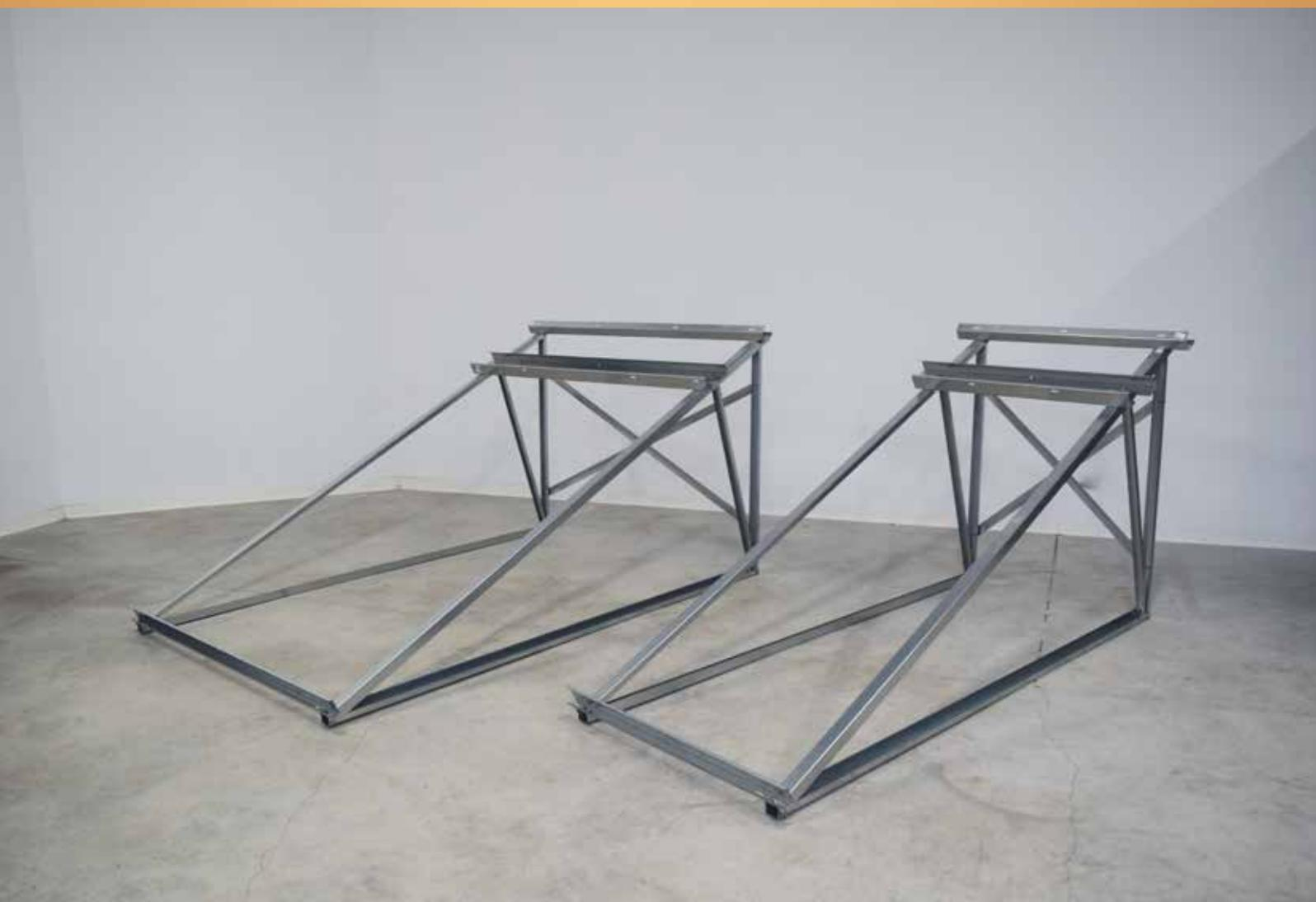
Las estructuras de captadores y calentadores solares Syrius son fabricados en lámina de acero Magnelis® con garantía de 20 años por Arcelor Mittal. El Magnelis® es una aleación de revestimiento que contiene magnesio. El magnesio permite una oxidación ligera en la superficie que protege también el acero de las intemperies y de condiciones extremas en zonas tropicales. Toda la tornillería se suministra en acero inoxidable A4.
