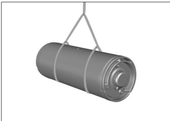
Lever le ballon sur le toit. Pour le montage, fixer deux cordes robustes, comme montré ci-contre. Nous recommandons d'utiliser une grue pour le levage. Travailler à deux : un installateur sécurise le ballon, le second le guide.
