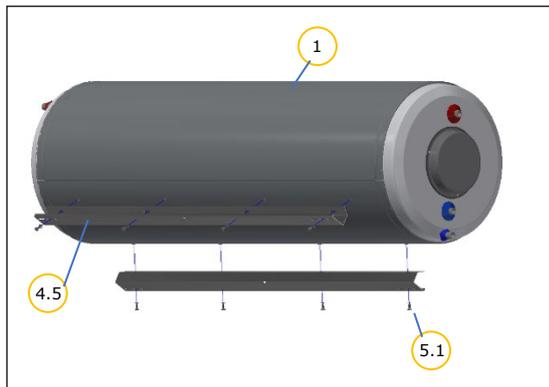
Fixer les traverses ballon (4.5 ou 4.6) sur le ballon avec les vis M8 (5.1).
