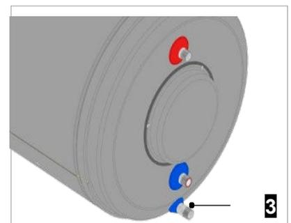
Raccorder la petite canne du kit hydraulique du haut du capteur au piquage chaud (5) et laisser le raccord ouvert (voir image ci-dessous).
