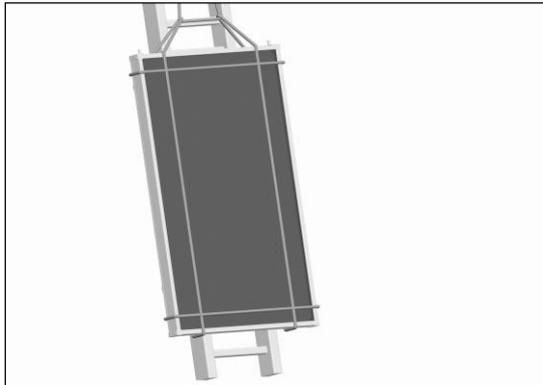
Lever les capteurs (3) sur la toiture. Pour le levage, fixer deux cordes robustes, comme montré ci-contre. Pendant la manipulation, vérifier que la corde ne recouvre pas les piquages en cuivre. Il est recommandé d'utiliser une grue pour le levage. Si nécessaire, utiliser, avec précaution, une échelle pour monter les capteurs sur le toit. Travailler à deux : un installateur sécurise les capteurs, le second le guide.
