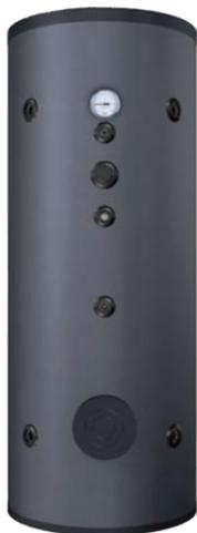
Les ballons de la série BVE-W sont spécialement conçus pour des installations solaires avec circuit primaire. Ils sont équipés d'un échangeur. La cuve et l'échangeur sont en acier émaillé. Les piquages de l'échangeur sont situés sur le côté à l'arrière du ballon, indépendamment de l'entrée eau froide et sortie eau chaude sanitaire situées en face avant. Ces ballons sont à poser au sol.
