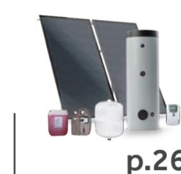
Le kit CESI auto-vidangeable comporte des composants adaptés de manière à ce que le circuit situé à l'extérieur de l'habitat se vidange automatiquement lors de l'arrêt du circulateur. Cela permet de supprimer les phénomènes de surchauffe en été ou de gel en hiver. Le circuit est à pression atmosphérique.
