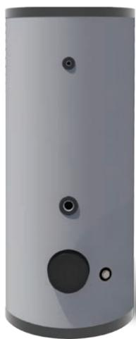
Les ballons de la série BVE-LWW sont spécialement conçus pour des installations solaires avec circuit primaire. Ils sont également équipés d'un échangeur grande surface (en haut) adapté pour des applications avec pompe à chaleur. La cuve et les échangeurs sont en acier émaillé. Ces ballons sont à poser au sol.
