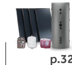
Dans ce kit SSC, la production d'ECS est instantanée via un serpentin inox et le circuit solaire est à pression atmosphérique. L'arrêt du circulateur permet de vidanger les panneaux pour les protéger du gel et des surchauffes éventuelles.
