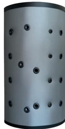
Le ballon tampon sert à stocker l'énergie thermique dans un système de chauffage. Il permet de combiner la production de chauffage et d'ECS instantanée par le biais d'un serpentin en inox 316L.
