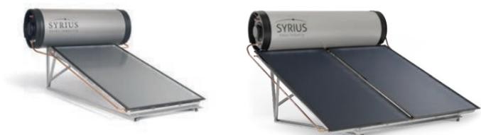
Il s'agit de la gamme thermosiphon avec ballons en acier émaillé. L'eau sanitaire circule naturellement dans les panneaux puis est stockée dans le ballon situé au dessus. Cette gamme offre l'avantage d'être particulièrement résistante à la corrosion.
