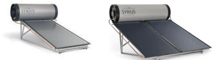
Il s'agit de la gamme thermosiphon avec ballons en inox. L'eau sanitaire circule naturellement dans les panneaux puis est stockée dans le ballon situé au dessus. Les thermosiphons inox ont l'avantage d'être légers, facilitant leur installation en toiture.
