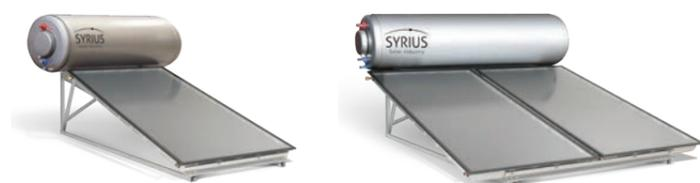
La gamme double paroi intègre des ballons à double enveloppe. L'eau sanitaire se trouve à l'intérieur du ballon, dans une double paroi comme un «bain-marie». Cette configuration permet l'utilisation d'eau glycolée dans les panneaux. Ce produit est recommandé pour une eau très calcaire ou corrosive.
