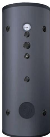
Les ballons de la série BVE sont spécialement conçus pour des installations solaires en circuit direct ou avec échangeur externe. La cuve est en acier émaillé. Ces ballons sont à poser au sol, et sont utilisés généralement en stockage solaire d'eau chaude sanitaire.
