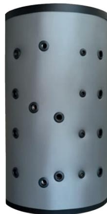
Les ballons tampon de la série BT-WWS sont utilisés principalement pour une installation en système solaire combiné (SSC). Ils permettent de combiner la production de chauffage et d'ECS instantanée par le biais d'un serpentin en inox 316L ainsi qu'un deuxième appoint par PAC ou chaudière.
